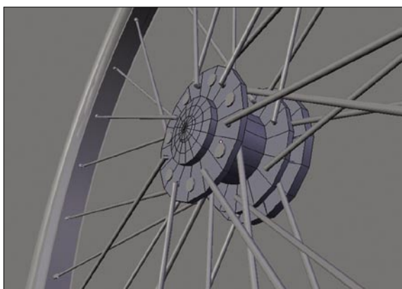
Rysunek 8. Gotowa piasta koła
